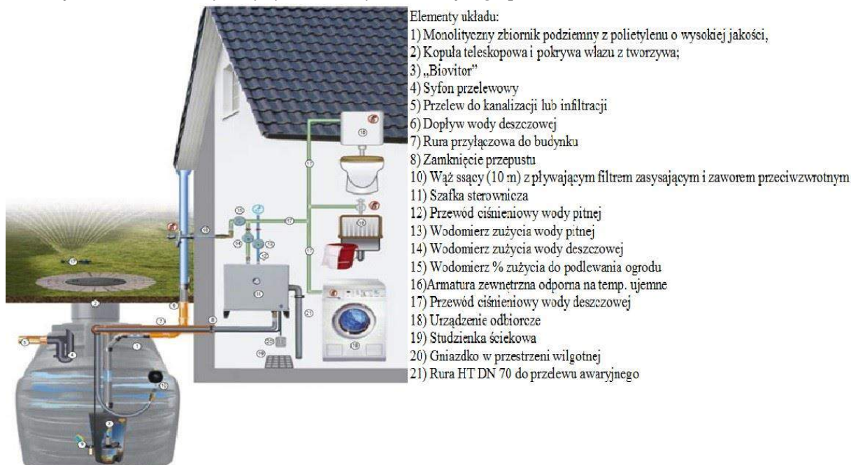
Ilustracja nr 19 Schemat wykorzystywania wody deszczowej w gospodarstwie
